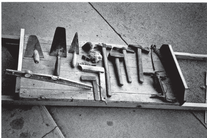
Imprescj dal muradôr. La civiere ch'a ten: il nivel, la cjacke par fâ mûr e la cjacke par smaltâ, cjaçulin par finiduris, fil a plomp, il rodul dal spali, martiel dai clauts, maçûl, martieline a ponte e scarpel par piastrelis, martieline par netâ planelis, taiâ madons e cops, tanais. Sot: scuaris primitivis di len, clarfis par leâ l'impalcadure (foto Luciano Cossio).
