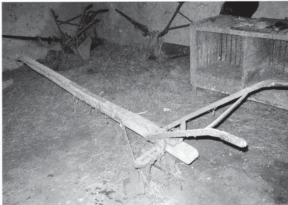
"Un dissaradôr. A jere la file da la blave, si tacave un cjaual tal cjarudiel e si tignive daûr il dissaradôr, che al faseve un piçul troi di ca e di là, par netâ la blave da la jerbe".
