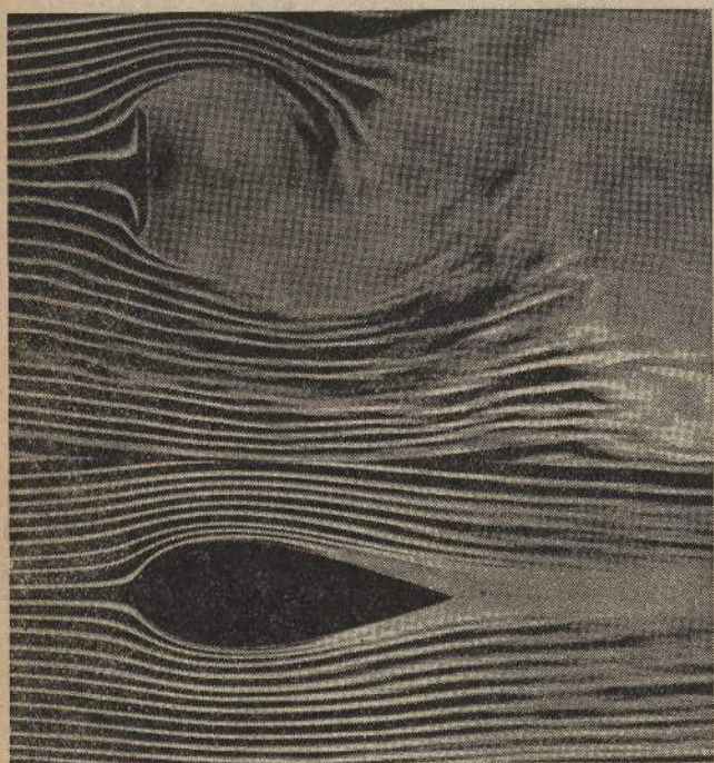
Eckiger Körper und Stromlinienkörper im Nebelkanal. ♦ Un oggetto angolare ed oggetti dinamici avvolti nella nebbia. ♦ Oggetti in aerodinamica obliqua v. cavi.
